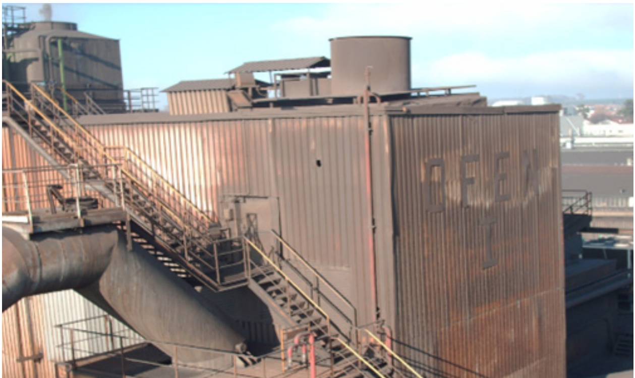
Ofenhaus einer Kupolofen-Schmelzanlage in einer mittelhessischen Gießerei.
