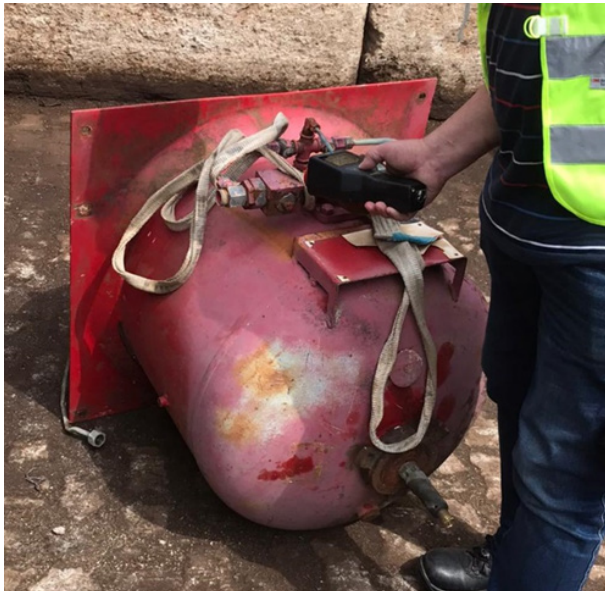
Verdächtiger Löschmittebehälter während der Aktivitätsmessung. © RP Gießen
